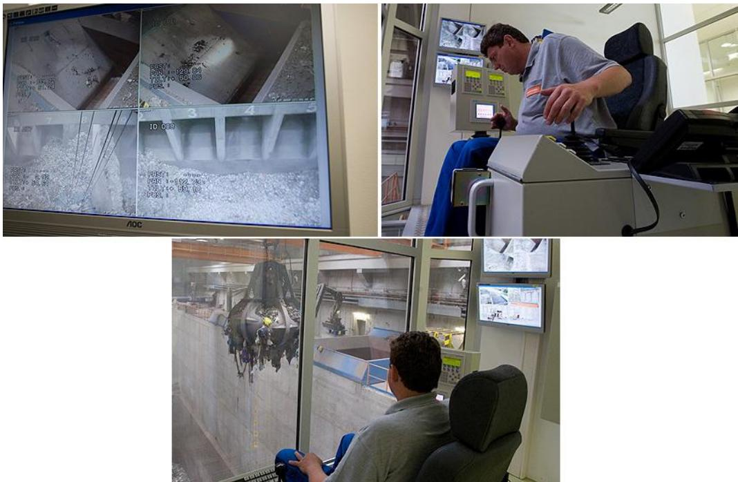
يتم تشغيل الرافعة من قبل عامل مختص تكون وظيفته الأساسية في ابقاء المنطقة العلوية متاحة لحركة الرافعة ، و خلط النفايات للمحافظة على درجة حرارة ثابتة وتغذية الحراق بالوقود بالإضافة الى انه يقوم بمراقبة النفايات الضخمة حتى لا تشكل عائق. جزء من الهواء المطلوب لعملية الحرق يسحب من هذا المستو عب مما يشكل ضغطاً منخفضاً يمنع انتشار الغبار و انطلاق الروائح.
